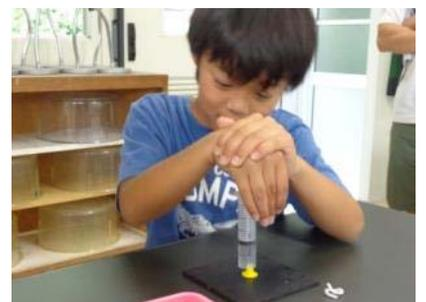
4年生のと同じく空気や水では、空気を圧縮するのにプラスチック製の注射器を使うことで、空気のもれがなく、手を放すともとの目盛のところまで確実に戻る実験器具を工夫することができた。
