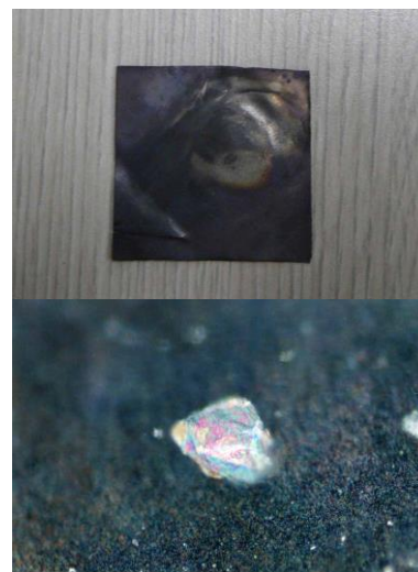
図 2 (a)反応後のモリブデン板(上)と (b)板状のダイヤモンド状化合物(下)
