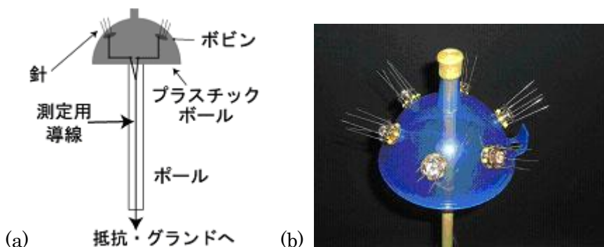
図3 コロナ・プローブ (a) 概略図 (b) 写真
