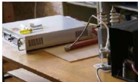
分ていどで、脱色可能な装置を作成できた。銅製の電極で効率よく脱色できるのは、電極から水中に溶け込む銅が触媒の働きをするためということがわかった。排水処理装置としての実用化のためには、銅が水中に溶解しないタングステン・アルミ電極が望ましいが、実践活動では、限られた時間で脱色する
