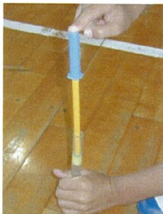
空気の弾力で押し棒を飛ばす
