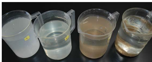
汚水のみ 汚水+空気 汚水+微生物 汚水+微生物+空気 COD 47 mg/l 23 mg/l 20 mg/l 8 mg/l
