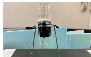
発生させたとき、その上にあるスチロール球の動きという動きのある結果を撮影し、音が小さい時と大きい時、低い時と高い時の粒子の動きの違いを比較させることで多くの気づきを得られるようにした。
