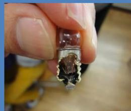
豆電球を分解して仕組みを確かめる
