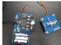
**見方・考え方を働かせる場の設定:**豆電球と発光ダイオードの電気の使われ方について「量的・関係的な見方」を用いて考察した児童は、より効率的な電気の使われ方について問題を作っていた。街灯を例に、効率的な電気の使われ方を Microbit を組み込んでプログラムした。①人感センサーを用いて、人が来た時だけ電流が流れ明かりがつく。②明るさセンサーを使って、照度が規定値以下の時だけ電流が流れる。①と②を組み合わせて、より効率的に電気を使うようにするなど、子どもたちは、よりよいプログラムを更新していった。その他、この見方をはたかせて、自動ドアやお湯がわいて知らせる電気ポットなどの仕組みを考えることにつながった。
