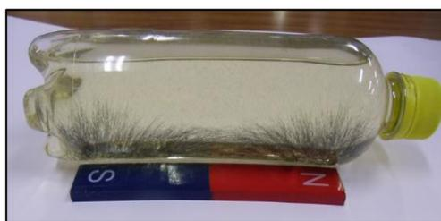
②ペットボトルの中にサラダ油を入れ、完成。ペットボトルを振り、均等にスチールウールを拡散した後、磁石を近づけることで視覚的に磁力が捉えられる。
