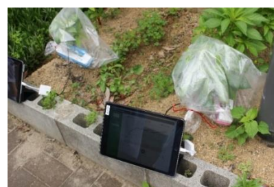
図1 センサーを利用して袋内の湿度を測定している様子
