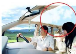
車体の上部に設置したカメラで撮影した空の映像をプロジェクターで車内の天井に表示するとオープンカーに乗っているような気分が味わえる。天井に表示されているのは上空の実際の映像である。夜間に星空の映像を表示すればロマンチックな気分も味わえる。
