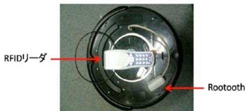
Fig. 1 RFID情報を収集する掃除ロボット
