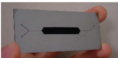
図2 パイレックスの蓋をかぶせる前のマイクロリアクターの写真。中央に黒く見えるのがナノチューブである。左側の2つのポートから基質を導入し、右側の1つのポートから反応液を取り出す。
