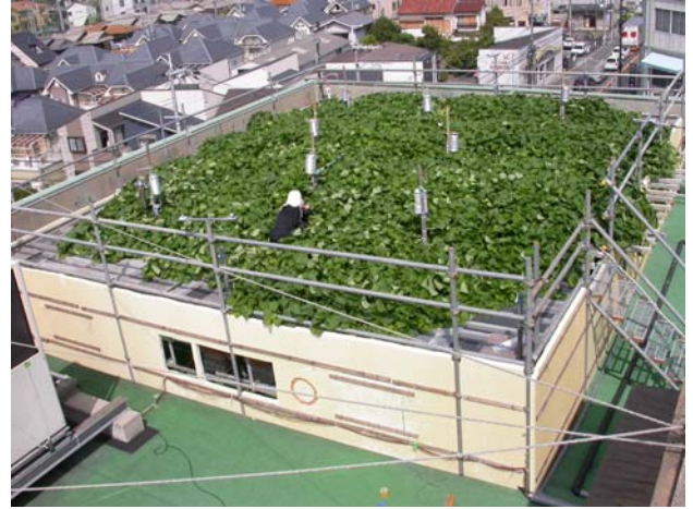
図3 水気耕栽培屋上緑化実験装置
