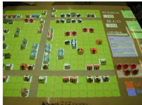
図4 拡張現実感技術を応用した協調学習支援環境。プロジェクトを介して、仮想世界のシミュレーション結果をセンシングボード上の物理世界に重ね合わせる。
