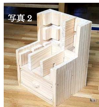
←ロボコン活用部門のプロトタイプ。試作したものを市内中学校に配布し、各学校で実機製作の見本やリンク機構、昇降機構の参考にした。
