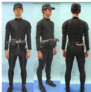
図1：全身に触覚センサを持つモーションキャプチャスーツ
