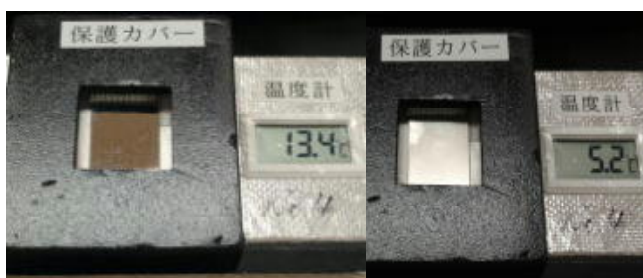
図 2 鏡面変化と温度
