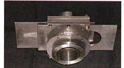
写真6 バイオマス材供給部
