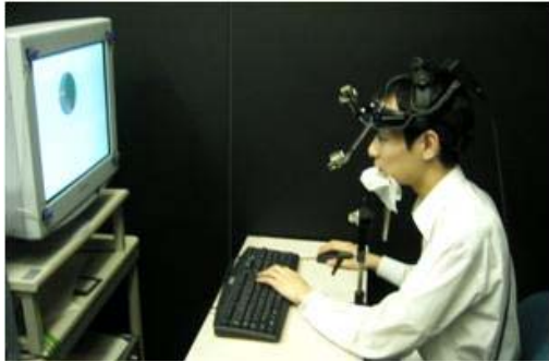
図 1. 実験装置と実験刺激画面. 画面は中心視条件実施中のものであり, CRT 画面中央よりやや上部の被験者が凝視している位置近傍の円形部分の内側だけに視覚刺激が提示されているのがみえる.
