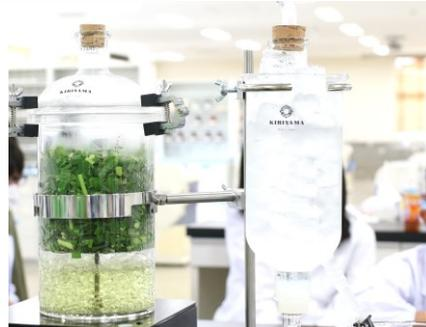
図2 レモングラスの水蒸気蒸留（シトラール抽出）
